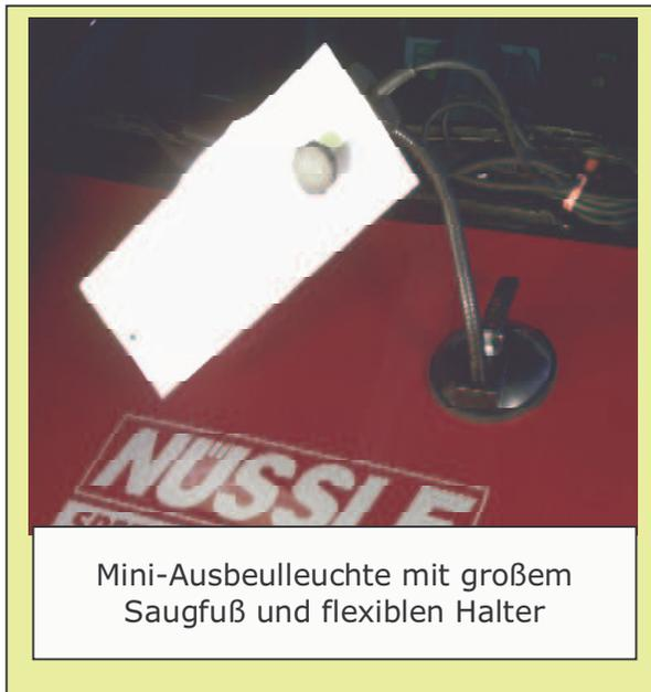
Mini-Ausbeulleuchte mit großem Saugfuß und flexiblen Halter
